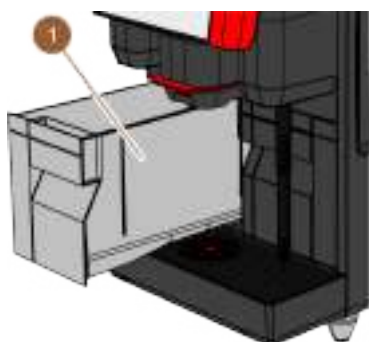
ill.: Réservoir d'eau potable interne
