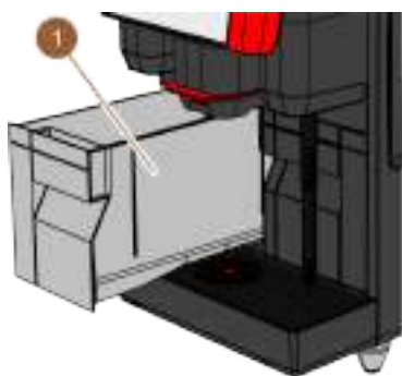
ill.: Réservoir d'eau potable interne
