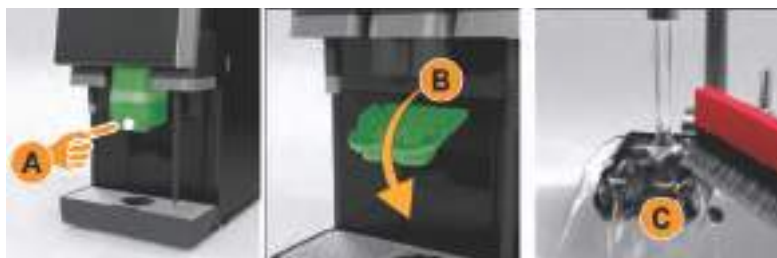
Ill.: Retrait couvercle partie inférieure sortie des boissons
