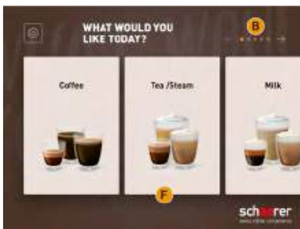
Ill.: Interface utilisateur « mode utilisateur racine » avec sélection par groupes de boissons
