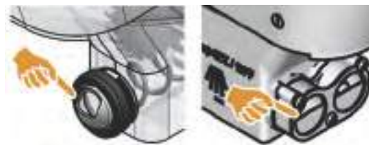
Ill.: Alignement de la tôle de dosage standard et de la version Twin sur le côté de la distribution du récipient à poudre.
